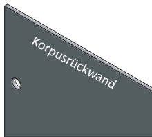
Korpusrückwand mit 12mm Bohrung.
